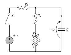
L'interruttore S si chiude in  $t_0 = 0s$ . Le equazioni di stato per questo circuito sono (per t > 0):
