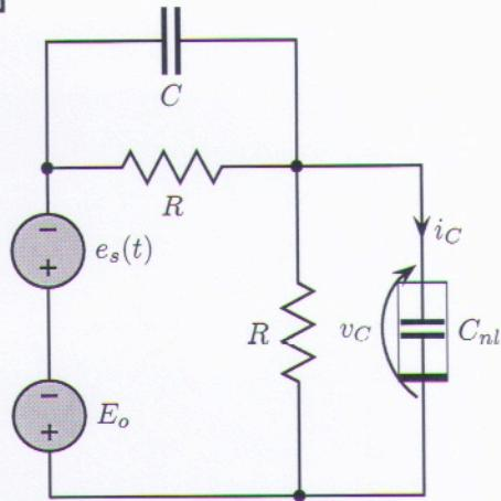
Il circuito di figura contiene un condensatore non lineare  $C_{nl}$  la cui relazione costitutiva è:
