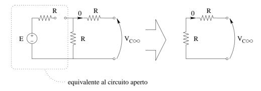
Ad interruttore aperto la serie del generatore di tensione, del resistore di sinistra e dell'interruttore sono equivalenti ad un circuito aperto, quindi otteniamo
