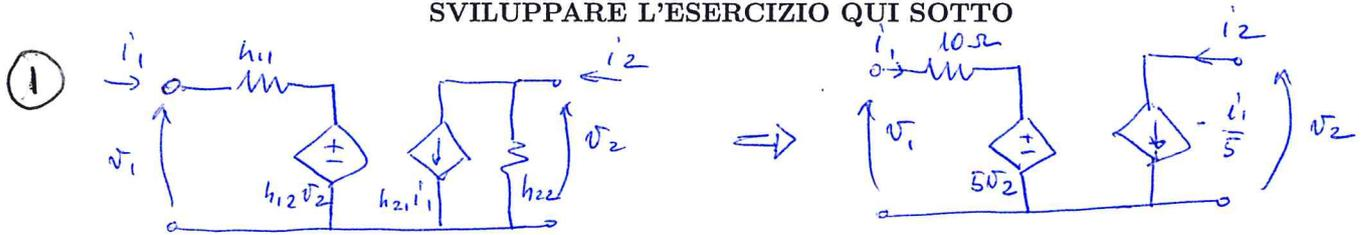
② Posto  $i_1 = i_A = 2$  [A] e  $v_2 = -R_B i_2 = -10 i_2$
