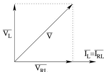
La tensione  $V$  però su questo diagramma non sarà orientata come nel diagramma precedente, visto che abbiamo assunto come riferimento per i due diagrammi due fasori diversi ( $I_C$  per il primo ed  $I_L$  per il secondo).
