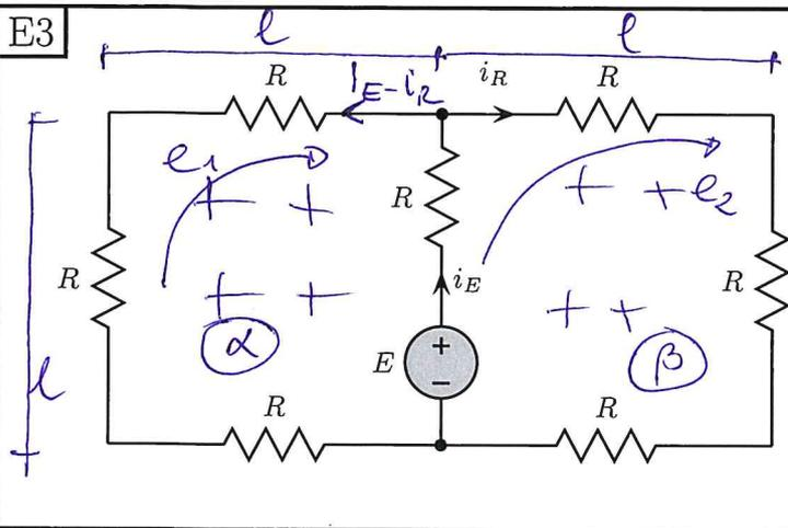
Il circuito di figura è immerso in un campo di induzione magnetica  $\mathbf{B}(t) = 0.1 \cos(10^3 t)$  [T] ortogonale al piano del foglio e orientato come in figura. Sapendo che:
