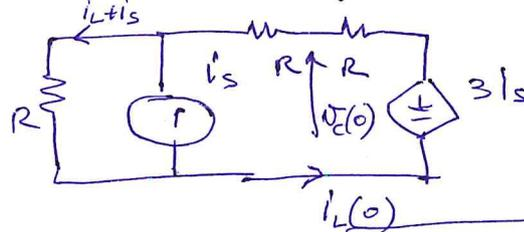
$$R(i_L + i_s) + 2Ri_L - 3i_s = 0 \rightarrow i_L(0) = \frac{3i_s - Ri_s}{3R} = 2A$$
