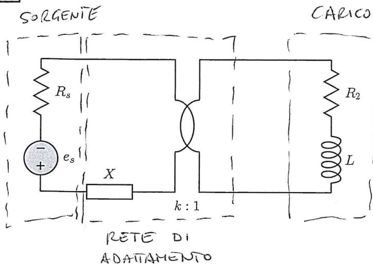
Il circuito di figura opera in regime sinusoidale ed contiene una sorgente ( $e_s, R_s$ ) e un carico ( $R_2, L$ ). Sapendo che:  $e_s = 40 \cos(10^4 t)$  [V],  $R_s = 10$  [k $\Omega$ ],  $R_2 = 100$  [ $\Omega$ ],  $L = 100$  [ $\mu\text{H}$ ], Determinare:
