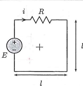
Un campo di induzione magnetica  $B(t) = B_0 t$  investe il circuito con l'orientazione riportata in figura. La corrente  $i$  nella maglia vale:
