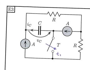
L'interruttore T è aperto e viene chiuso all'istante di tempo  $t_1=1$ ms. Sapendo che:  $v_C(0)=1$ V, A=2A,  $R=\frac{1}{2}\Omega$ , C=1mF si chiede di:
