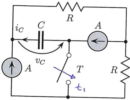
L'interruttore  $T$  è aperto e viene chiuso all'istante di tempo  $t_1 = 1\text{ms}$ . Sapendo che:  $v_C(0) = 1\text{V}$ ,  $A = 2\text{A}$ ,  $R = \frac{1}{2}\Omega$ ,  $C = 1\text{mF}$  si chiede di:
