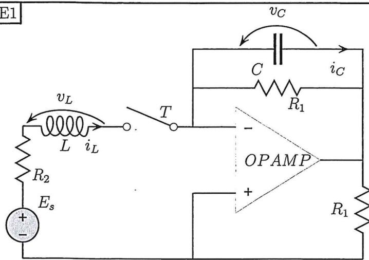
Nel circuito dinamico di figura, l'interruttore  $T$ , aperto da molto tempo, viene chiuso all'istante  $t_0 = 0$ . Sapendo che:
