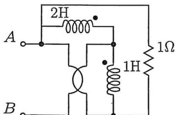
Il bipolo ai morsetti  $AB$  opera in regime sinusoidale con  $\omega = 1\text{rad/s}$ ,  $M = 2\text{H}$  ed ha impedenza  $z_t$  ed ammettenza  $y_t$ . Risulta:
