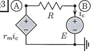
Volendo scrivere per il circuito di figura le equazioni dell'analisi nodale modificata **senza l'uso dei supernodi**, che dimensione avrà il sistema risolvete?
