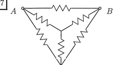
Tutti i resistori valgono  $4\Omega$ . La resistenza equivalente ai morsetti AB vale:
