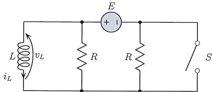
L'interruttore  $S$ , aperto da molto tempo, viene chiuso all'istante  $t_0 = 0$  per poi essere riaperto all'istante  $t_1 = 1\text{ms}$ . Sapendo che:  $L = 1\text{H}$ ,  $R = 10\Omega$ ,  $E = 100\text{V}$
