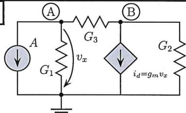
Si utilizza l'analisi nodale (senza supernodi) per la soluzione del circuito:
