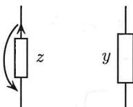
Sia data un'impedenza  $z = 1 + J1 \Omega$  e la sua ammettenza equivalente  $y$ .
