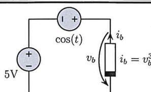
Nel circuito di figura, la resistenza differenziale da utilizzare nell'analisi per piccoli segnali vale:
